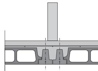
Pokud je hmotnost příček  $\leq 2,5$  ( $3,5$ )  $\text{kN/m}$  stačí zdvojit nosníky NORD pod příčkou pro požadované zatížení při tloušťce dobetonované desky  $e = 40$  ( $50$ )  $\text{mm}$ .
